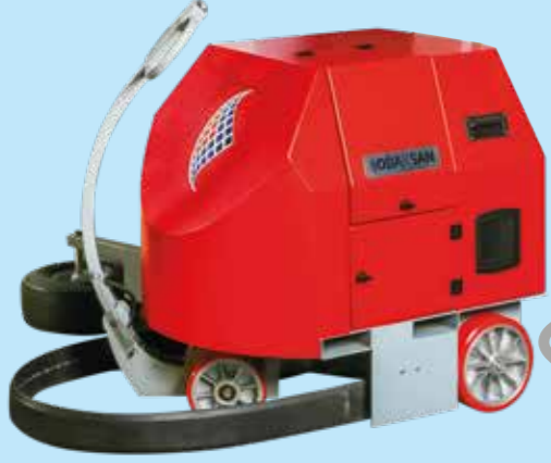
İÇTEN DESTEKLİ METAL GÖVDE Internal Supported Metal Body ÇELİK SAC EMNİYET BARIYERİ Steel Sheet Safety Barrier
